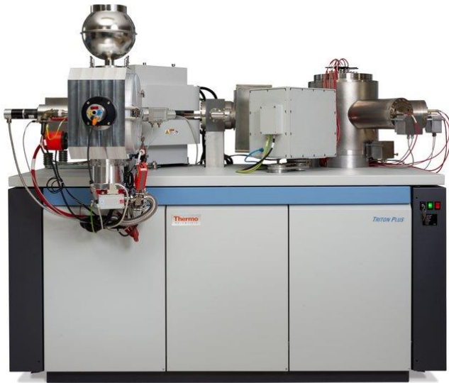
多接收热电离质谱仪 (MC-TIMS) : 双稀释剂法 (double-spike)
